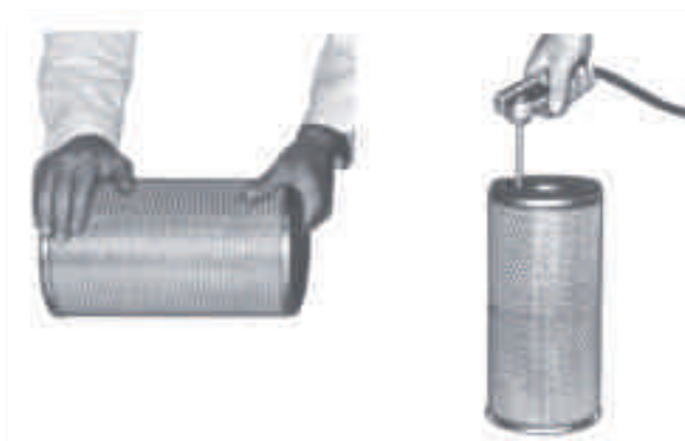
Figura 69 - Limpeza dos filtros
